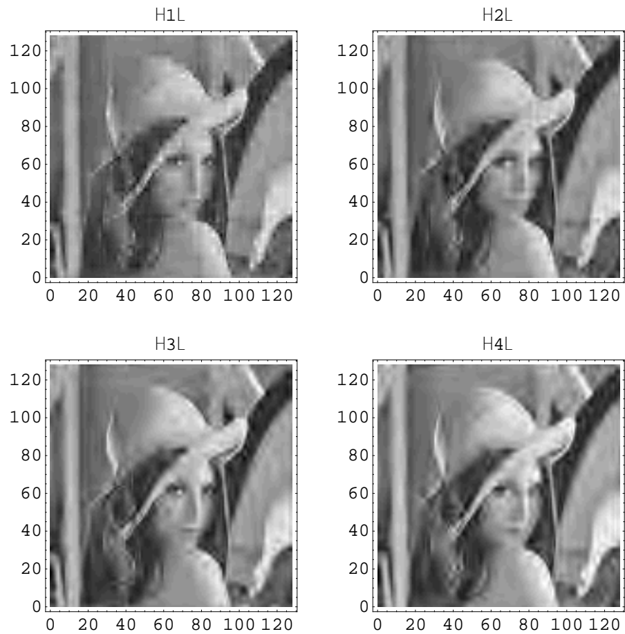
図6. 約13%に閾値法で圧縮されたデータから再現されたイメージ、図中の番号(1)-(4)はそれぞれ、coif6からcoif24の基底関数による結果を示す
