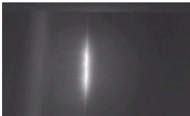
図 3.2 接合部分を含む鉄板赤外線画像
