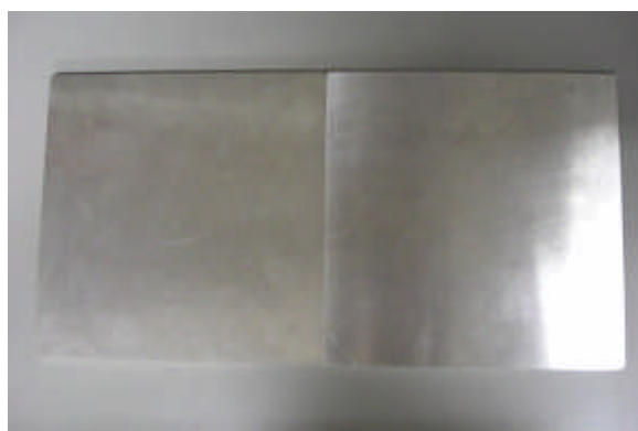
図 3.1 接合部分を含む鉄板
